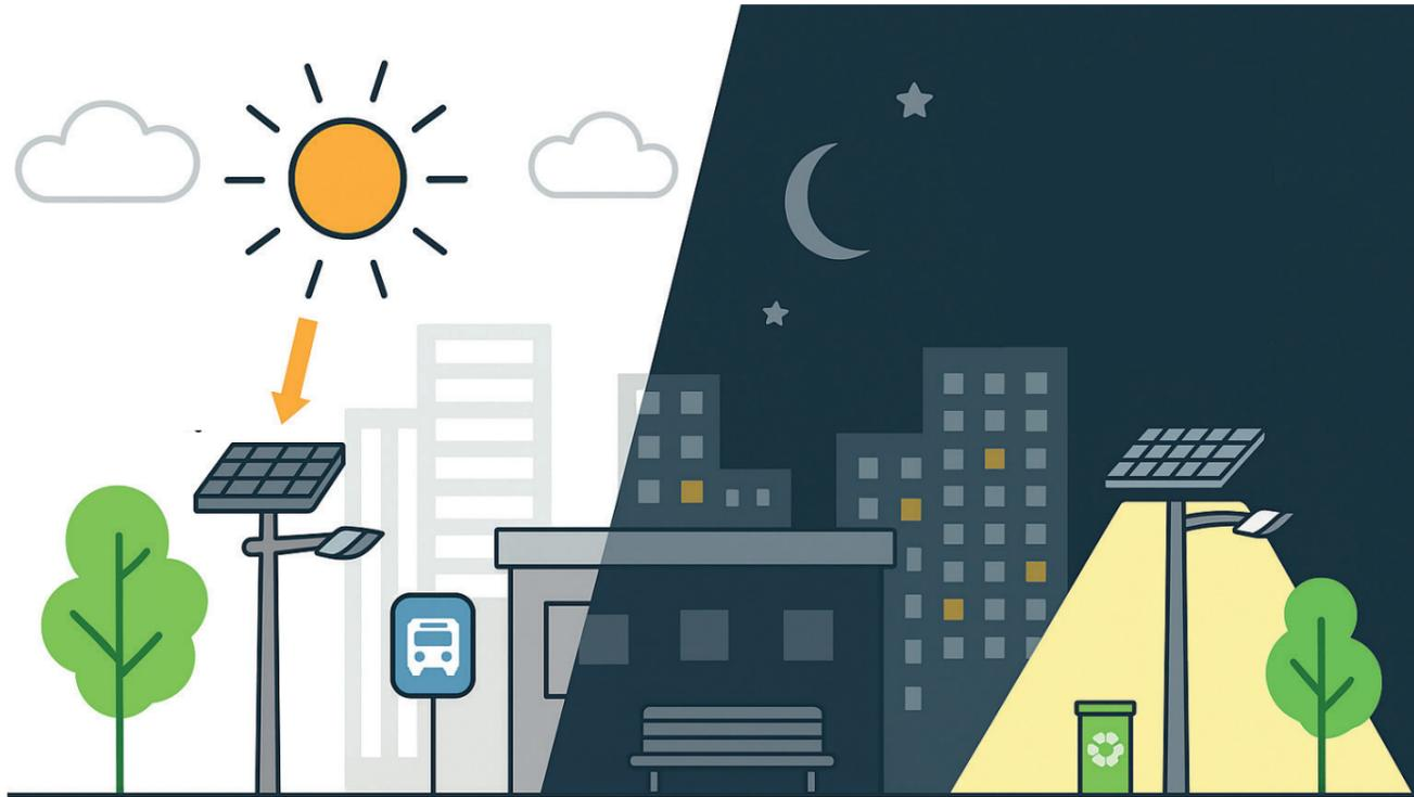
Tagsüber nimmt das Photovoltaikmodul die Energie der Sonne auf und speichert sie in der Batterie.
